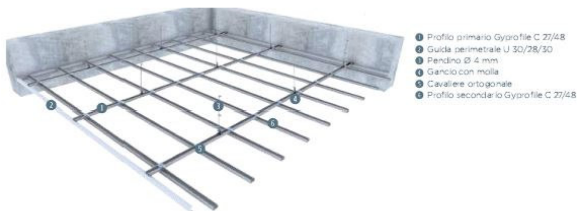
Figura 18 - Schema di montaggio
